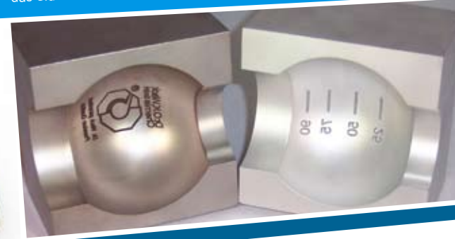
Lasergravur von Blasformen aus Stahl und Aluminium.
