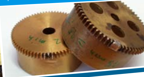
Reparaturschweißung von Getriebebauteilen.
