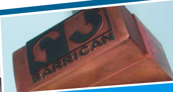
Lasergravur auf der balligen Oberfläche einer Kupferelektrode.
