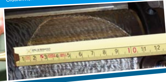
Reparaturschweißungen von Glasformen aus Guss und Bronze.
