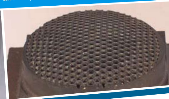
3D Lasergravur einer Graphitelektrode für eine Lautsprecherabdeckung (Waben 1x1mm).
